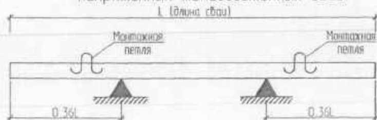
Рисунок 1.2. Схема испытаний предварительно напряженных железобетонных свай
