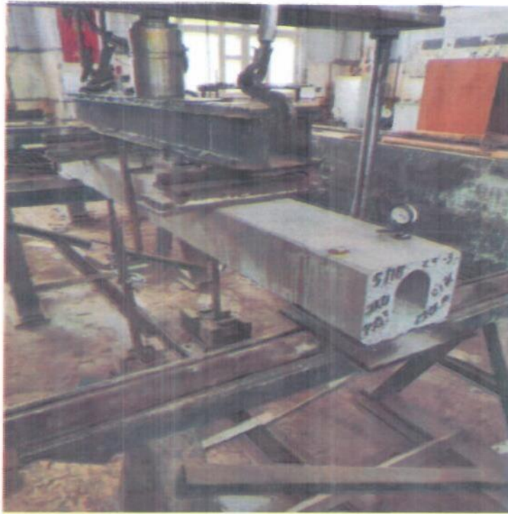
Фото № 1. Общий вид испытаний железобетонной предварительно напряженной перемычки СПБ25-37.
